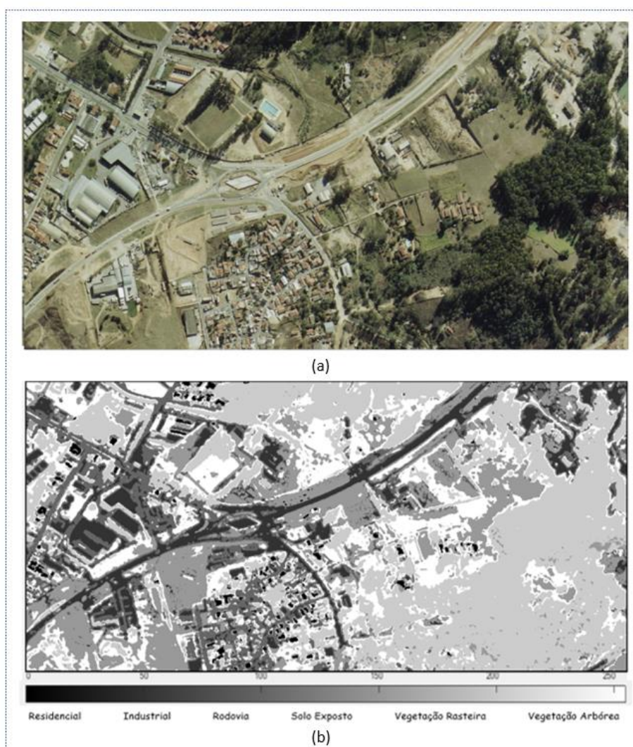
Figura 54: Resultado do sistema para a sub-imagem 3 – (a) Sub-imagem do entorno da Rodovia Raposo Tavares na altura do km 95; (b) Imagem classificada e segmentada
