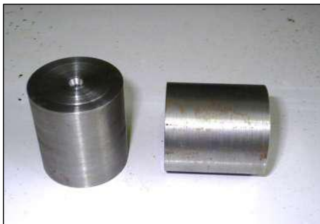
Figura 20: Ilustração do tarugo utilizado para impressão do rebolo
