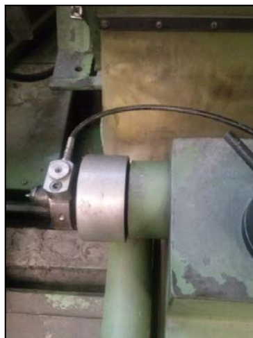
Figura 29: Sensor para captação da emissão acústica
