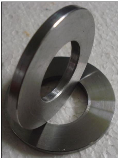
Figura 19: Ilustração do formato do corpo de prova usado
