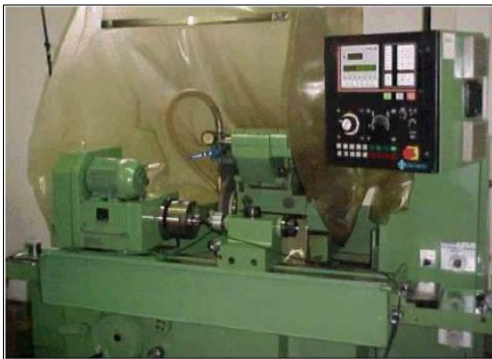
Figura 17: Retificadora cilíndrica CNC Sulmecânica - RUAP 515 H
