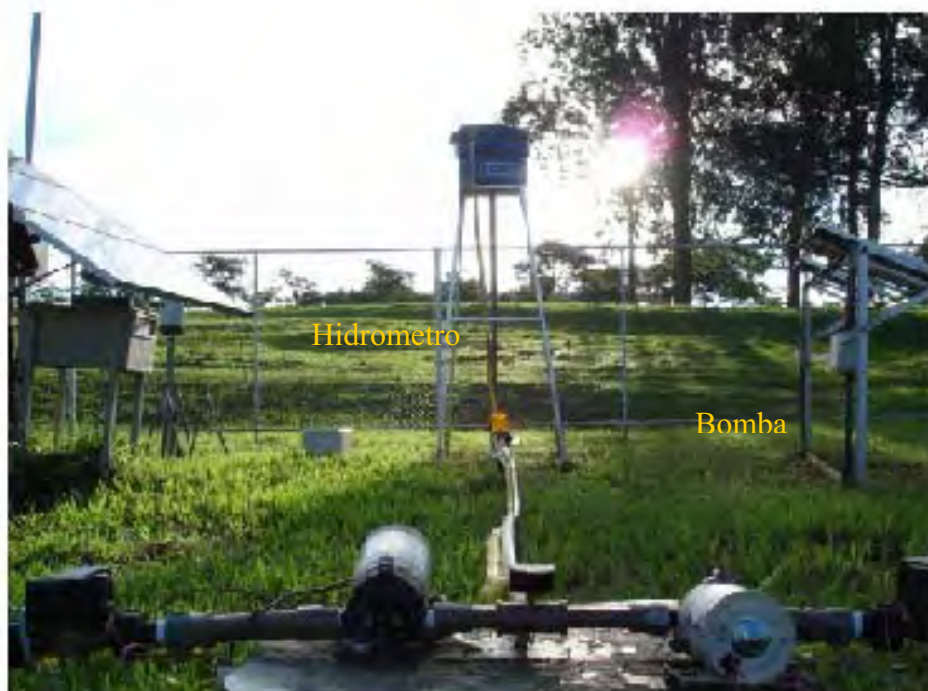
Figura 14 – Sistema Hidráulico, bombas e caixa superior
