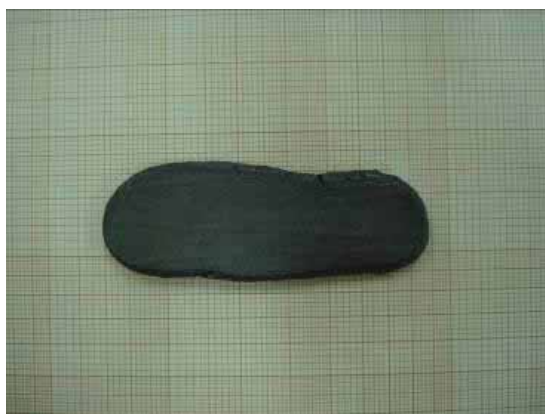
Figura 17 - Fotografia do lingote da liga Ti-15Mo-20Nb, após (a) laminação e (b) decapagem química.
