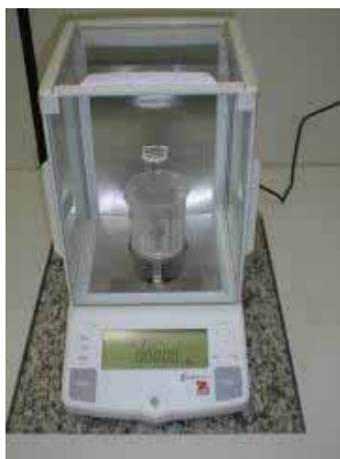
Figura 18 – Balança analítica com o kit utilizado nas medidas de densidade.
