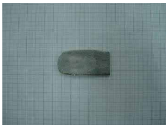
Figura 17 - Fotografia do lingote da liga Ti-15Mo-20Nb, após (a) laminação e (b) decapagem química.
