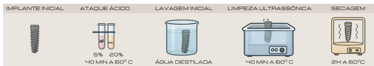
Fig 2 Desenho do procedimento de tratamento de superfície realizado no implante. Fonte: Elaborado pelo autor.
