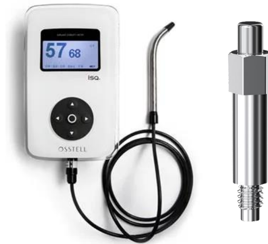
Fig 4 Dispositivo para mensuração da estabilidade do implante através da frequência de ressonância. O aparelho Osstell (à esquerda) e o dispositivo para adaptação no implante chamado de SmartPeg (à esquerda).
