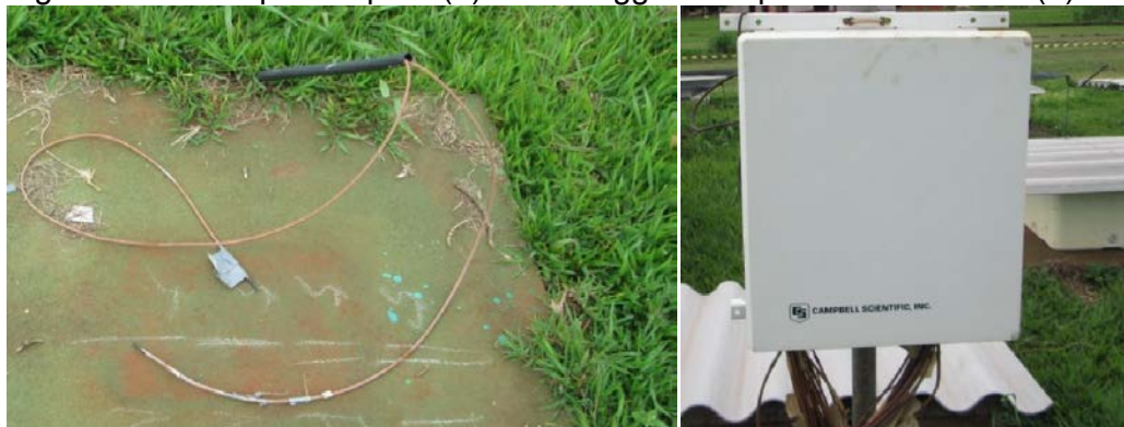
Figura 3 – Termopares tipo T (a) e Datalogger Campbell Scientific-INC(b)
