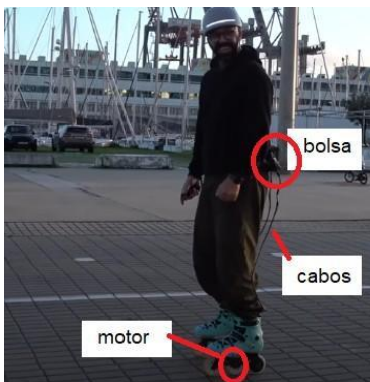
Figura 7 - Patins elétricos com freio mecânico
