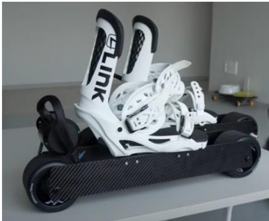
Figura 12 - Patins construído a partir de kit de componentes de skate elétrico
