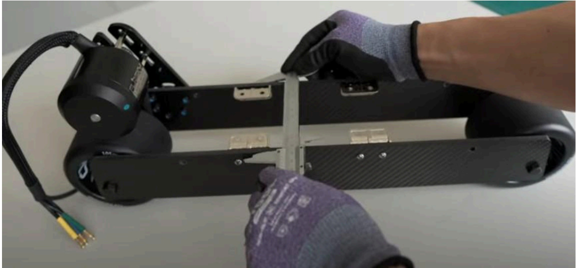
Figura 13 - Montagem inicial da base
