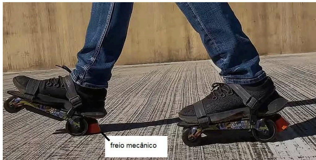
Figura 4 - Patins elétricos com freio mecânico
