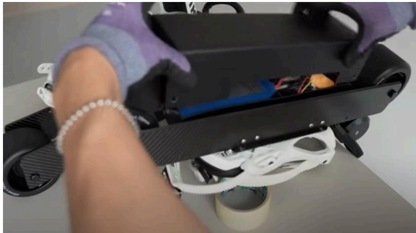
Figura 17 - enclausuramento dos componentes elétricos
