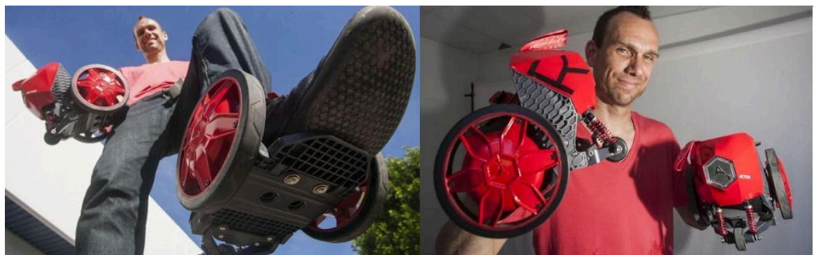
Figura 9 - Patins com 3 rodas e amortecedor
