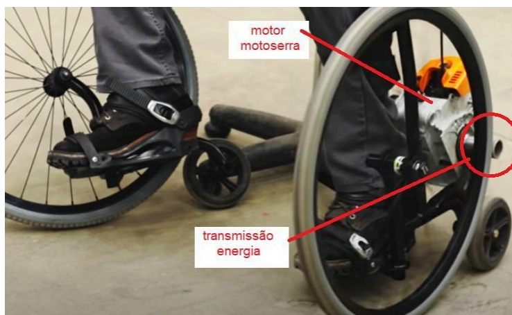
Figura 28 - Acoplamento motor de motosserra
