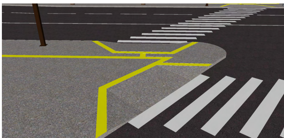
Figura 96 – Detalhe da rampa de acesso
