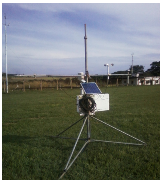
Figura 2. Estação Agroclimatológica (EMA-EA).
