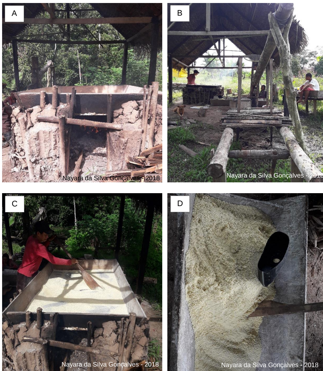
Figura 15 - Forno para a secagem da farinha (a), acessório para a retirada da água da mandioca prensada (b), processo de secagem (c) e farinha pronta reservada em estrutura de madeira (d)
