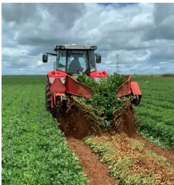
Figura 2. Conjunto trator-arrancador utilizado na propriedade de Taiuva-SP.
