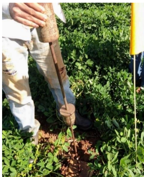
Figura 6. Penetrômetro de impacto manual.
