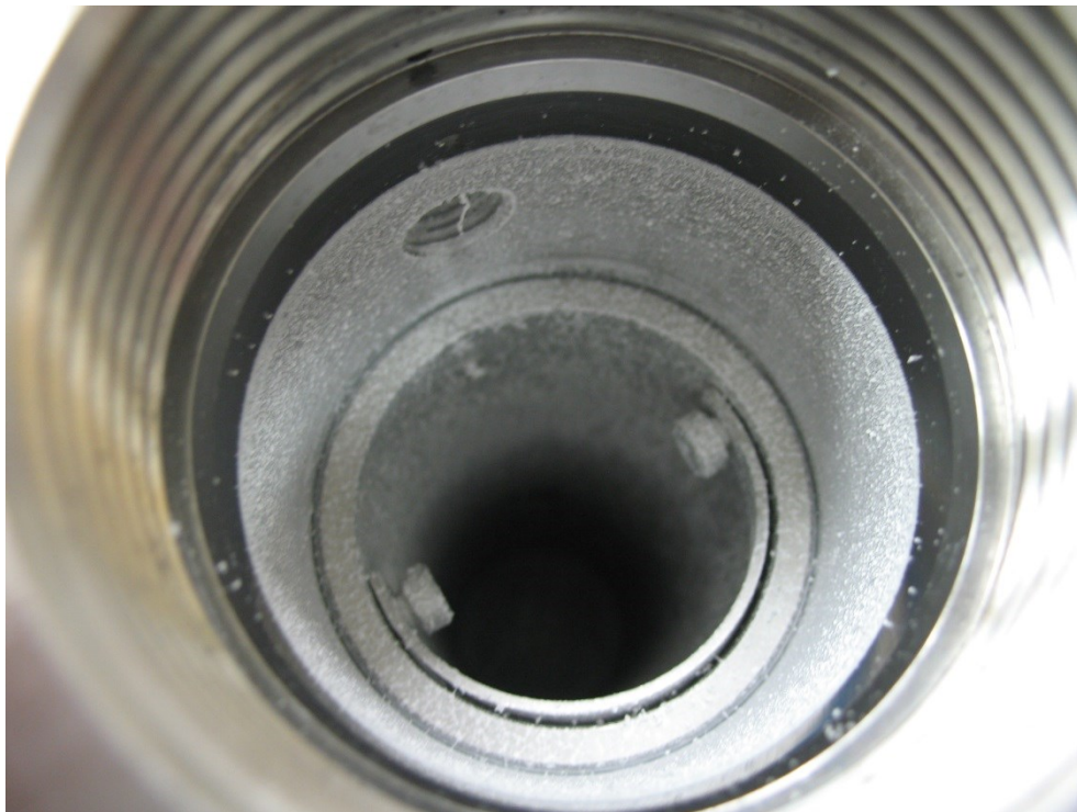
Figura 4: Fotografias do vaso coletor do equipamento FSC contendo sólido particulado de aspecto não uniforme e sólido filamentososo (++).
