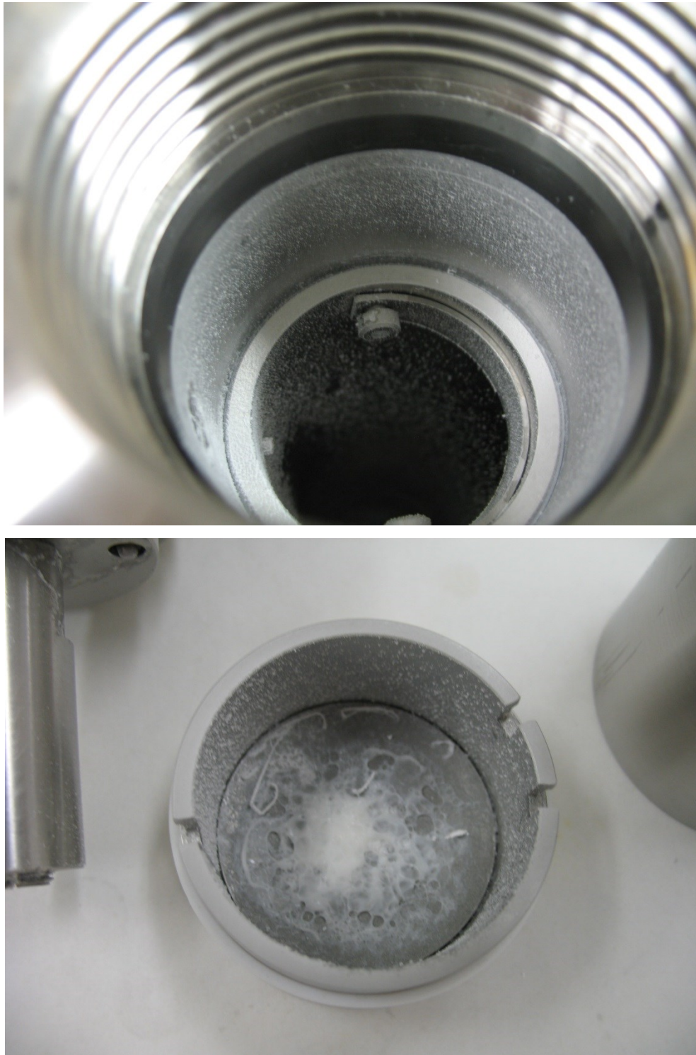
Figura 5: Fotografias do vaso coletor do equipamento FSC contendo sólido não particulado (+).
