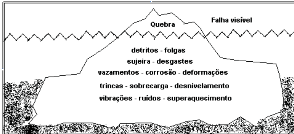
Figura 2.6 Ilustração sobre falhas invisíveis que podem ser evitadas com a TPM. (Sampaio, 2010)
