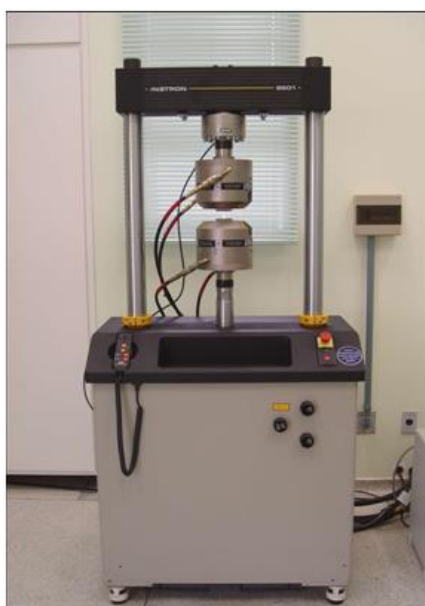
Figura 50 – Máquina servo hidráulica INSTRON utilizada nos ensaios de mecânica da fratura.
