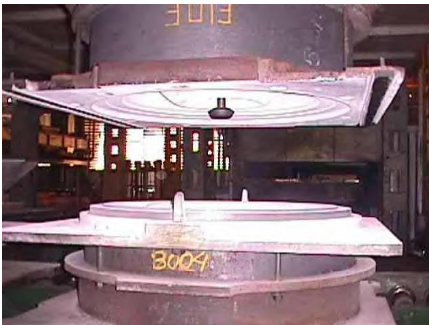
Figura 40 – Ilustração do molde fundo e molde tampa. (RIBEIRO, 2008)
