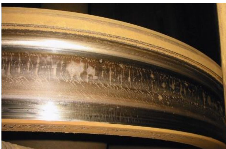
Figura 23 – Trincas térmicas na pista de uma roda ferroviária (HANDA; MORIMOTO, 2012).
