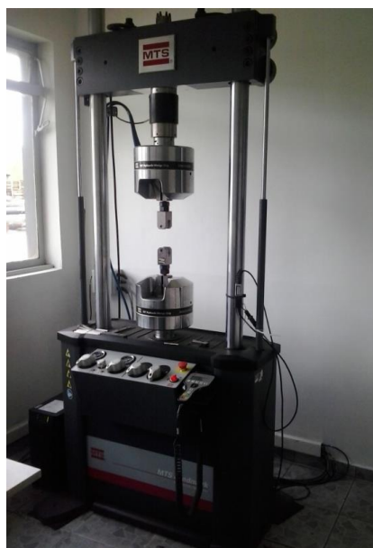
Figura 57 – Máquina servo hidráulica MTS utilizada nos ensaios de fadiga.
