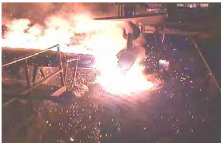
Figura 39 – Etapa de vazamento do aço para a panela (RIBEIRO, 2008)
