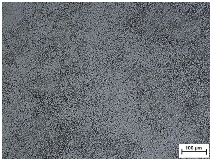
Figura 75 - Tamanho de grão austenítico do aço "CMW" (Forjado Microligado). Ataque: 6g de ácido pícrico + 300 ml H 2 O + 15 ml de sulfonato de sódio a 60°C. Ampliação 100 x.
