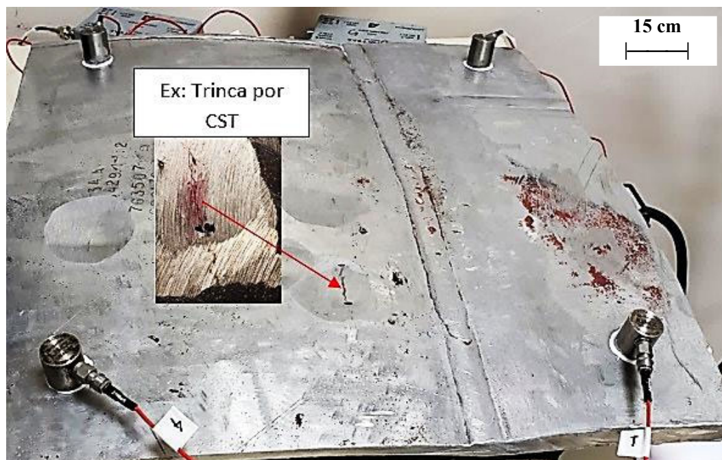
Figura 62 - Esquema de montagem dos sensores para monitoramento do corpo de prova.
