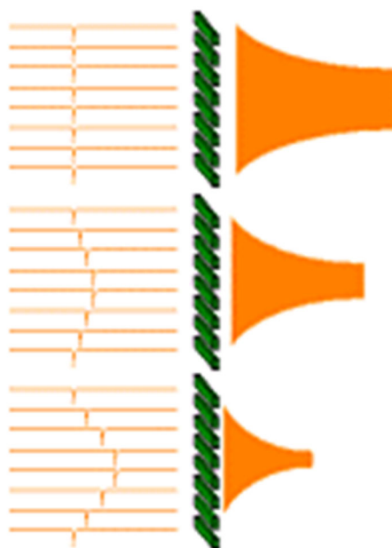
Figura 10 - Esquema de focalização eletrônica (aplicação de leis de retardos eletrônicos é usada para focalizar o feixe).
