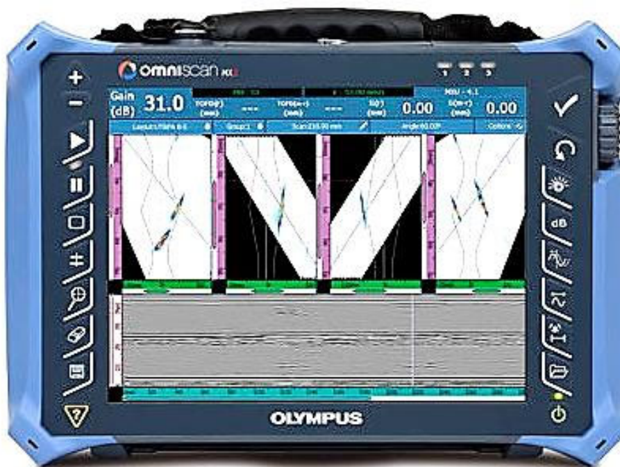
Figura 21 - Aparelho de ultrassom OmniScan MX2 com visualização no modo TOFD.
