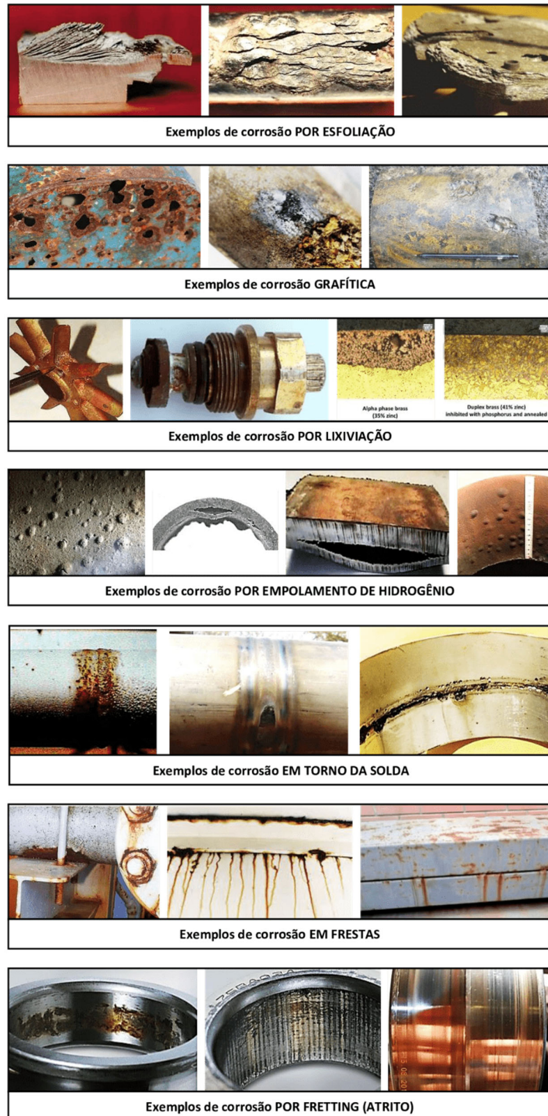
Figura 34 - Casos onde peças metálicas foram fragilizadas via corrosão por esfoliação, gráfica, lixiviação seletiva, em juntas soldadas, frestas e fretting.
