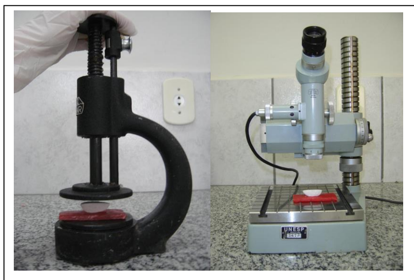
Figura 9 – Espécime de gesso no paralelômetro/ Espécime de gesso no microscópio de mensuração
