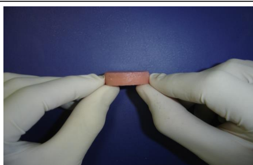
Figura 5 - Disco de resina acrílica ativada termicamente recoberto por reembasador resiliente acrílico. Espécimes estocados em saliva artificial a 37 \pm 1^\circ\text{C}
