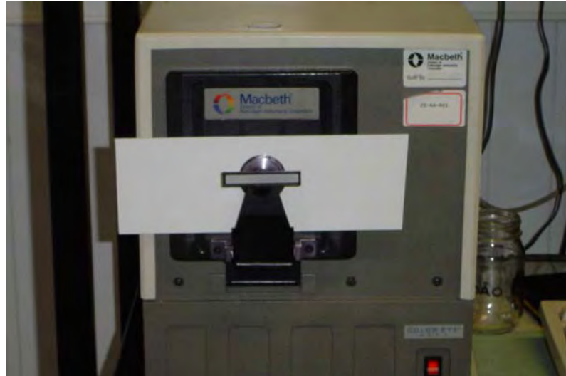
FIGURA 19 – Leitura sendo realizada sobre a placa metálica branca no Espectrofotômetro Color Eye.
