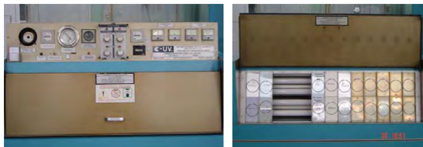
FIGURA 12 – Equipamento empregado para o envelhecimento acelerado para não-metálicos – Ultravioleta B / condensação (Matérias Primas Ind. Com. Ltda., SP, Brasil).
