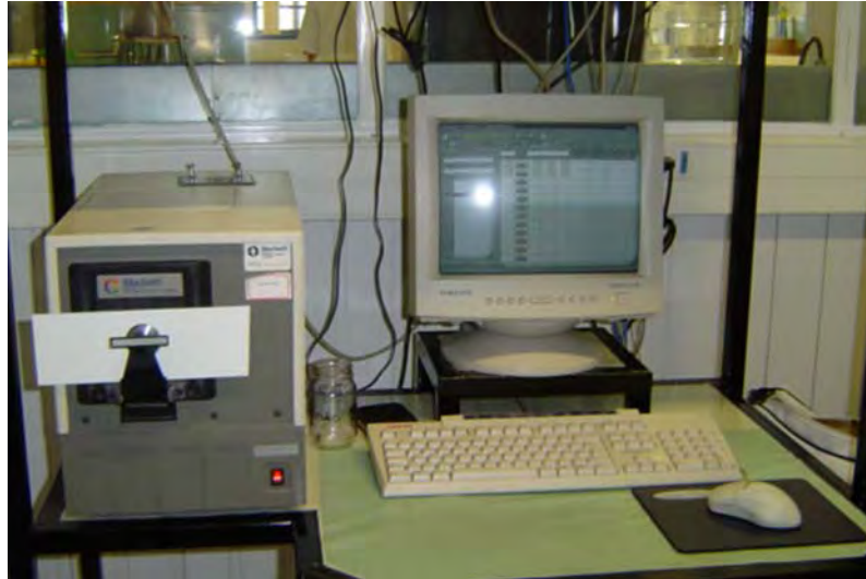
FIGURA 16 – Espectrofotômetro Color Eye (MacBeth ® Divisão da Kollmorgen, USA).
