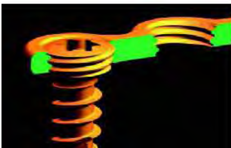
Figura 9: Figura da placa locking mostrando as roscas na cabeça do parafuso e no buraco da placa.
