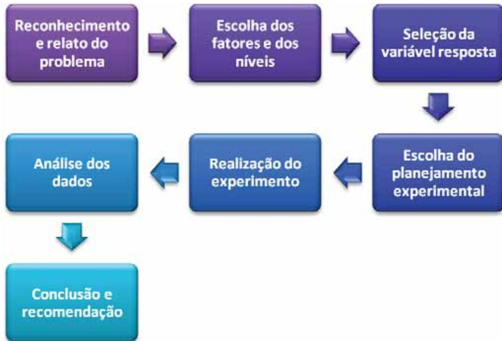
Figura 16 - Sistematização de projeto de experimento.[Adaptado de Montgomery 1997].
