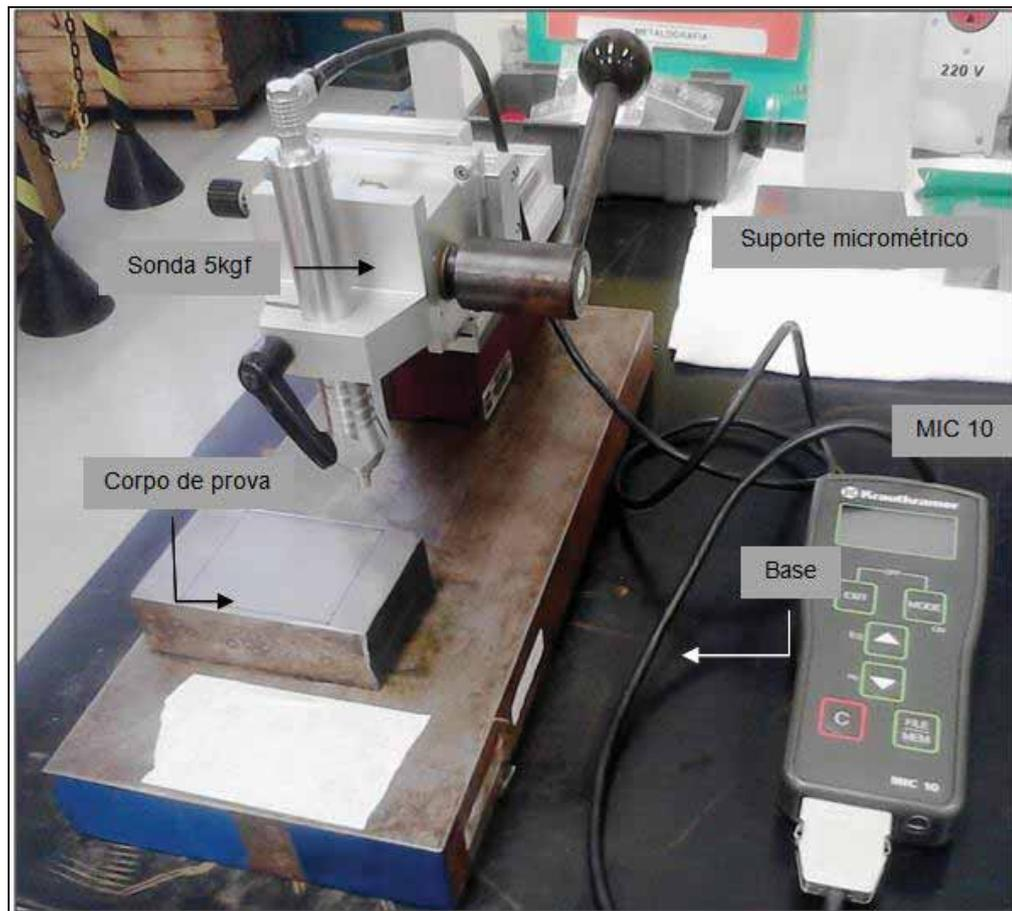
Figura 23 - Ensaio de dureza com durômetro portátil MIC 10.
