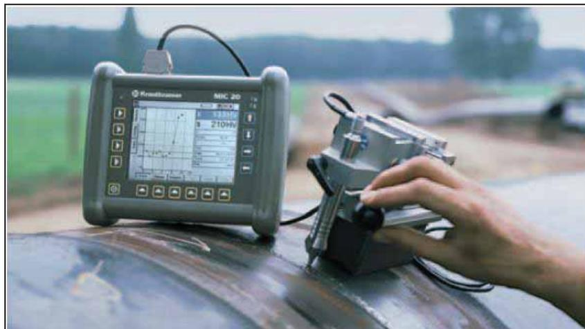
Figura 8 - Equipamento de dureza portátil de método UCI modelo MIC 20 da marca GE.
