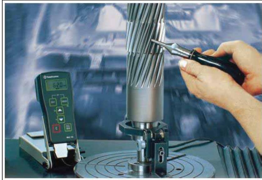
Figura 9 - Equipamento de dureza portátil de método UCI modelo MIC 10 da marca GE.
