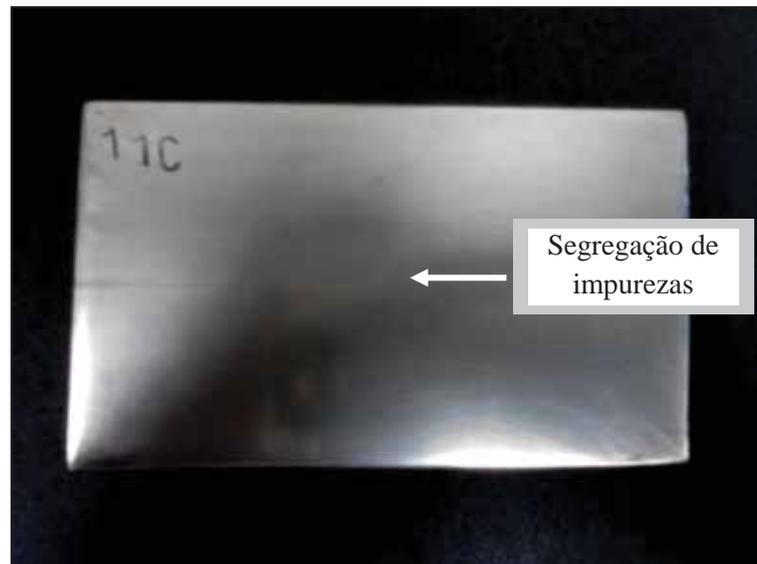
Figura 21 - Corpo de prova 11 Nital 10% e lixamento até 1200 - segregações de impurezas na parte central da peça.
