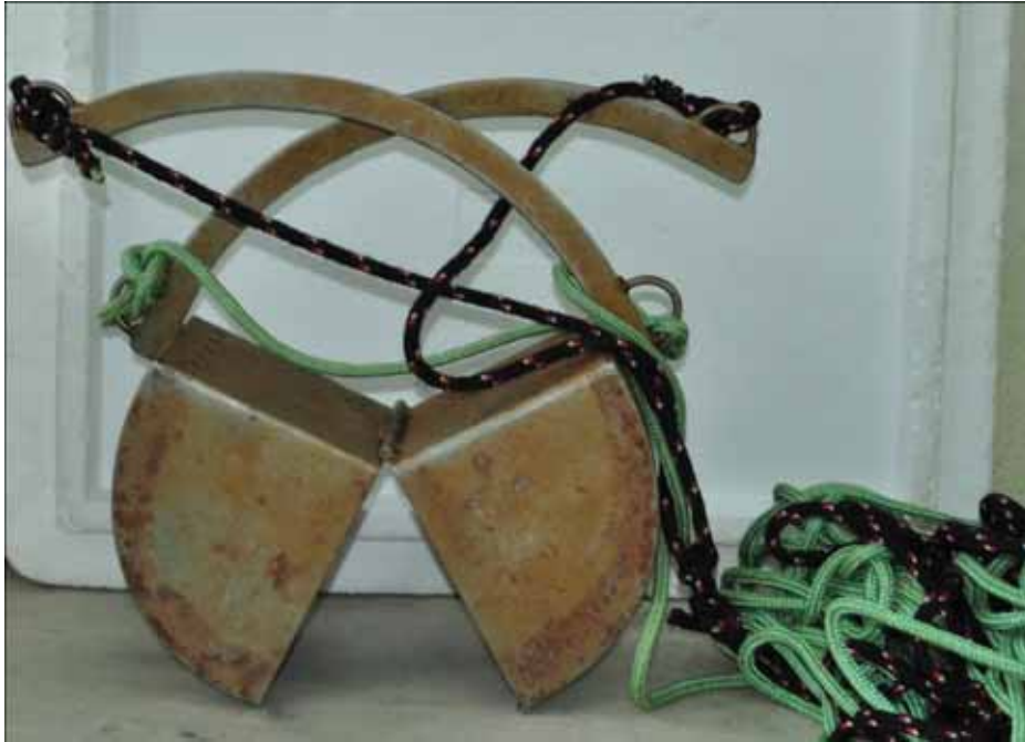
Figura 4. Pegador de Van Veen utilizado para amostragem de sedimento.
