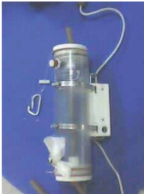
Figura 3. Garrafa de Van Dorn utilizada para amostragem de água de superfície e de fundo.
