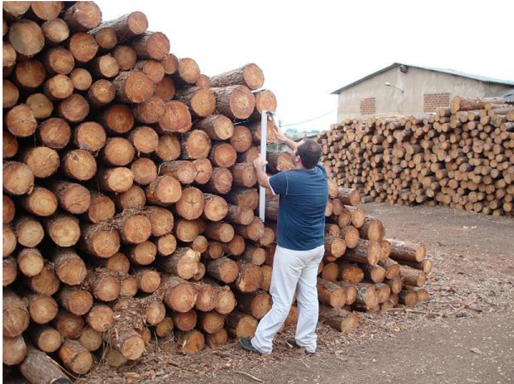
Figura 16 – Colocação dos gabaritos na pilha
