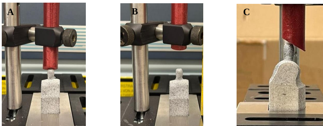
Figura 4. Corpo de prova fixado na posição com o dispositivo chanfrado em 30° em relação ao longo eixo do implante. A, dispositivo abaixado em contato com o corpo de prova. B, dispositivo elevado para troca do corpo de prova. C, vista lateral do dispositivo em contato com o corpo de prova
