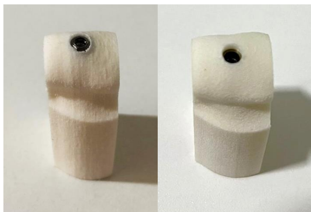
Figura 11 - Da esquerda pra direita, posição final do implante HE no corpo de prova. Posição final do implante GM no corpo de prova
