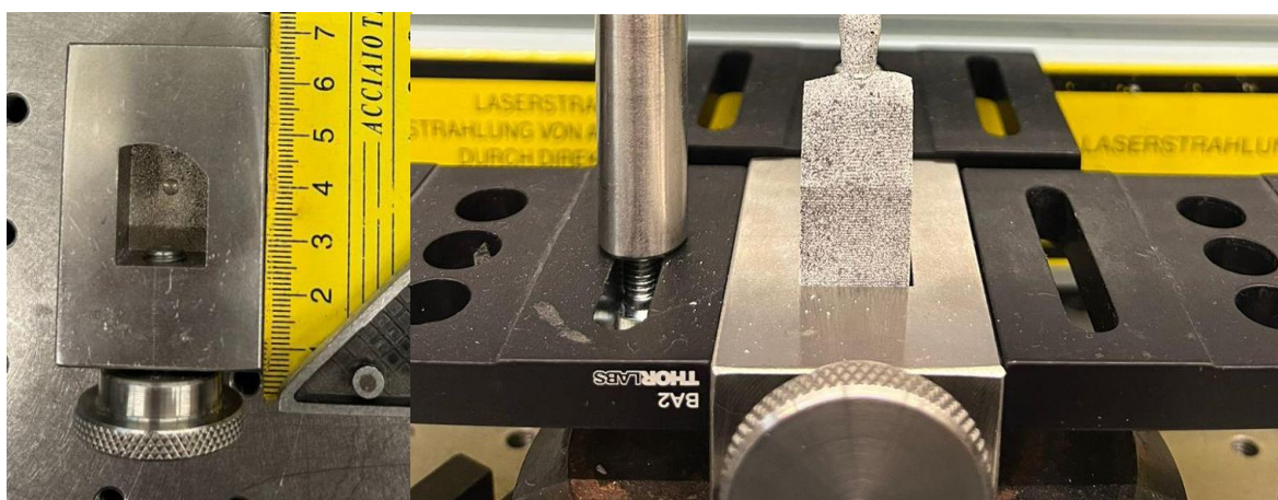
Figura 14 - Da esquerda pra direita, dispositivo confeccionado em aço inox com o encaixe feito no formato dos corpos de prova. Dispositivo preso na bancada por grampos que estabilizaram e padronizaram a posição, permitindo apenas que fossem trocados os corpos de prova
