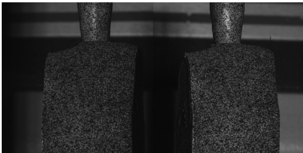
Figura 19 - Imagens capturadas dos corpos de prova do implante HE, pelo software VIC-3D
