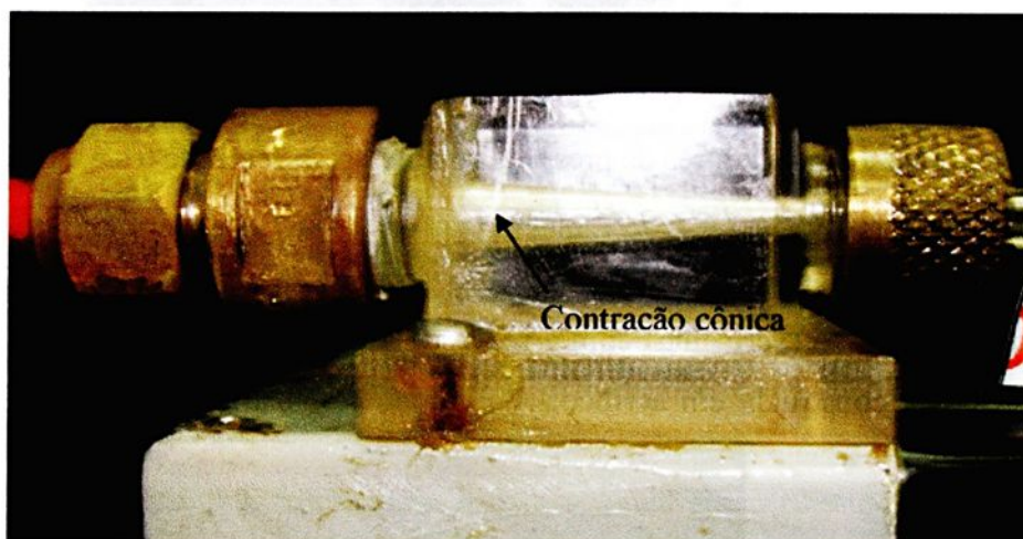
Figura 3.6 – Visualização da contração de acrílico da seção de teste de tubo de vidro.
