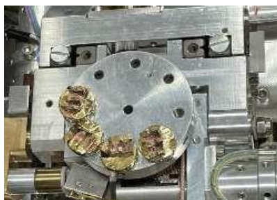
Figura 11. Amostras metalizadas com ouro em metalizador.
