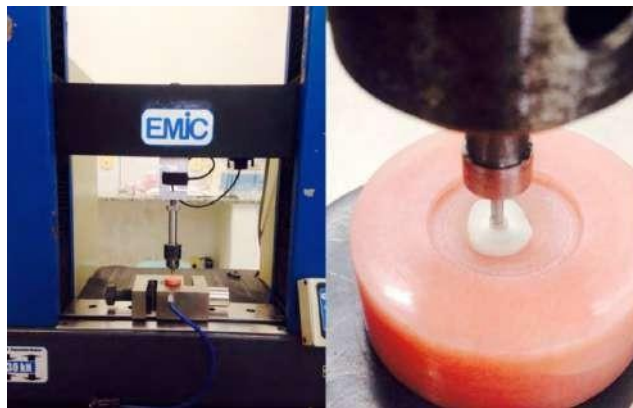
Figura 10. A. Máquina universal EMIC DL3000. B. Haste metálica posicionada no centro do pino do corpode prova.
