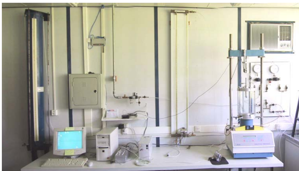
Figura 4-2 - Vista geral do equipamento utilizado para Realização de Ensaios Triaxiais no Laboratório de Mecânica dos Solos da Unesp – Bauru.
