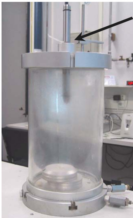
Figura 3-8 – Foto de uma câmara triaxial destacando o pistão para aplicação de carga vertical.
