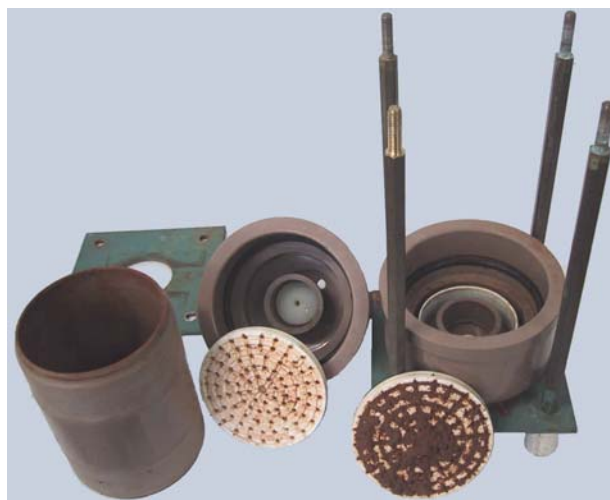
Figura 4-14 – Coluna utilizada para compactar os corpos-de-prova e percolar as soluções e a água.
