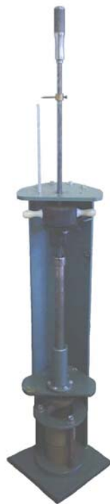
Figura 4-12 - Equipamento utilizado para compactar os corpos-de-prova.
