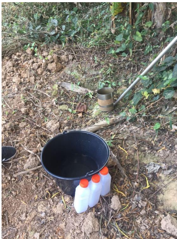
Figura 11 - Materiais utilizados para a coleta das amostras: coletor de metal, balde de plástico e garrafas plásticas
