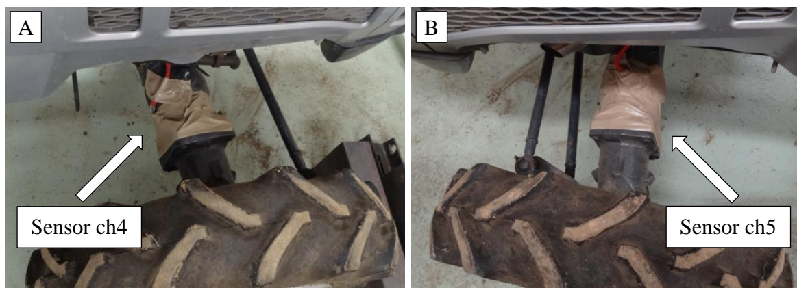
Figura 16. Sensor ch4 (A) e sensor ch5 (B) instalados no trator agrícola
