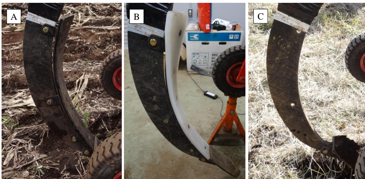
Figura 12. Haste com defletor metálico (A), defletor plástico (B) e sem defletor (C)
