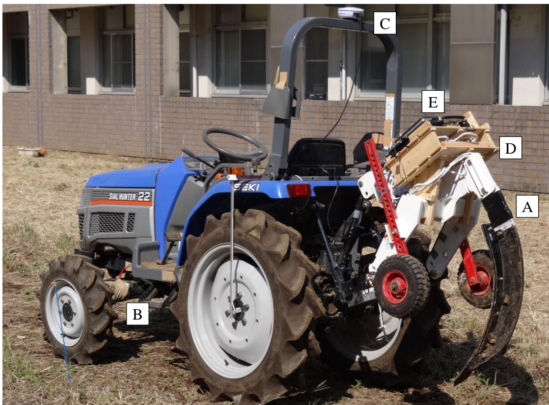
Figura 27. Trator agrícola instrumentado para realização dos ensaios
