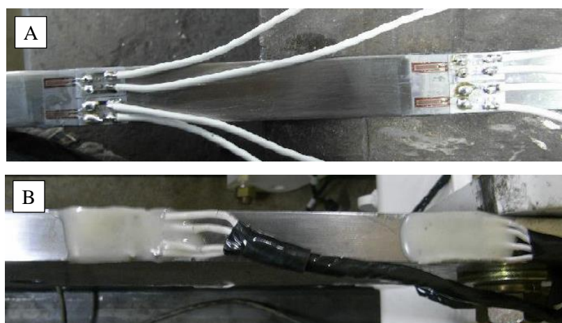
Figura 15. Extensômetros elétricos de resistência antes (A) e depois (B) do cola isolante
