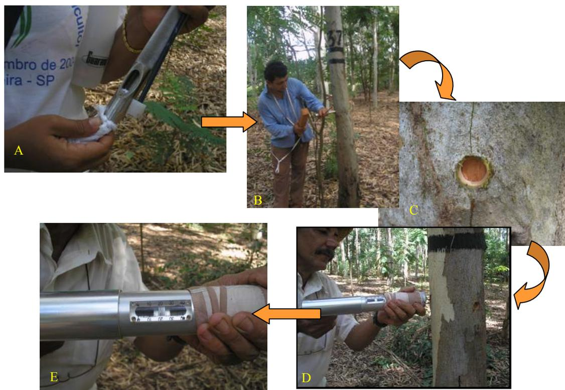
**Figura 4.** Aparelho utilizado para a retirada da casca (A); perfuração da árvore (B); orifício para a mensuração da resistência à penetração (C), demonstração da medição com o aparelho *Pilodyn Wood Tester* (D) e demonstração da medição em milímetros (E).
