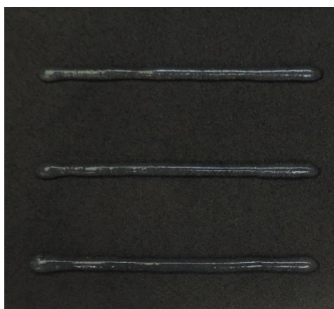
Figura 9. Teste de printabilidade. Filamentos produzidos com 1%FU 2%AG 2%SA com agulha de 1,2 mm e velocidade impressão 10 mm/s
