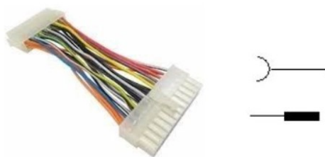
Figura 31 – (a) Conectores para fontes ATX™, (b) e (c) símbolos esquemáticos
