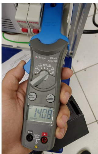
Figura 50 – Validação dos dimensionamentos, corrente no alimentador.
