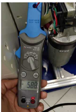
Figura 49 – Validação dos dimensionamentos, corrente no motor.
