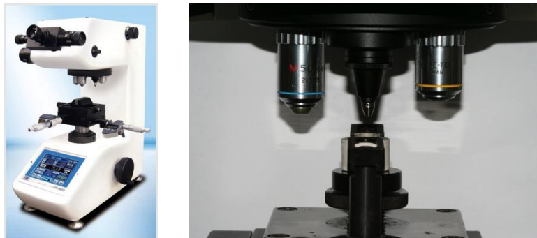
Figura 11 – Microdurômetro utilizado com indentador Knoop .
