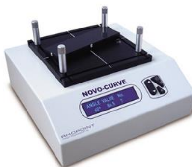
Figura 10 – Equipamento para determinação do brilho superficial.
