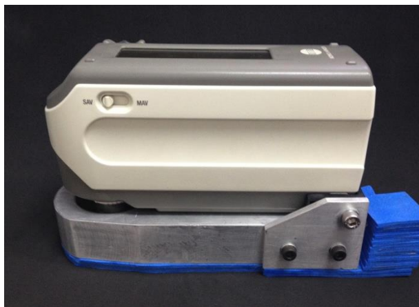
Figura 8 – Espectrofotômetro utilizado para determinar alterações de cor.
