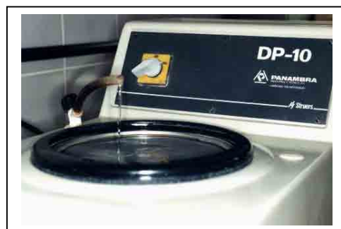
Figura 09 - Politriz Circular Mecânica Struers -para regularização e uniformização da smear layer .
