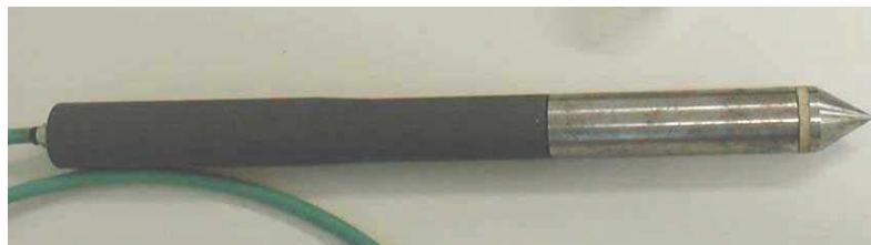
Foto 3.2: Piezocone com medida de poro-pressão atrás da ponta ( U_2 ) (Giacheti, 2001).
