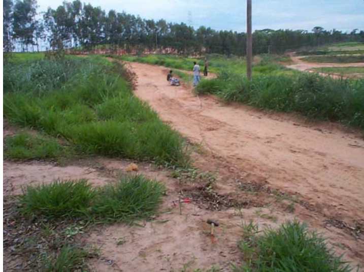
Foto 4.5: Ensaio de Eletrorresistividade de Superfície pela técnica do Caminhamento Elétrico Dipolo-Dipolo, sendo executada no aterro de Bauru.
