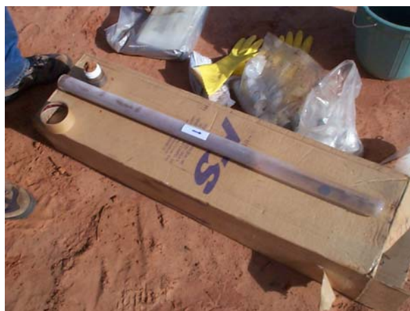
Foto 4.7: Amostragem de solo utilizado no aterro de Bauru utilizando o Geoprobe®.
