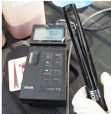
Foto 4.17: Condutivímetro Thermo-Orion modelo 115 utilizado na calibração do dispositivo para medida de resistividade.
