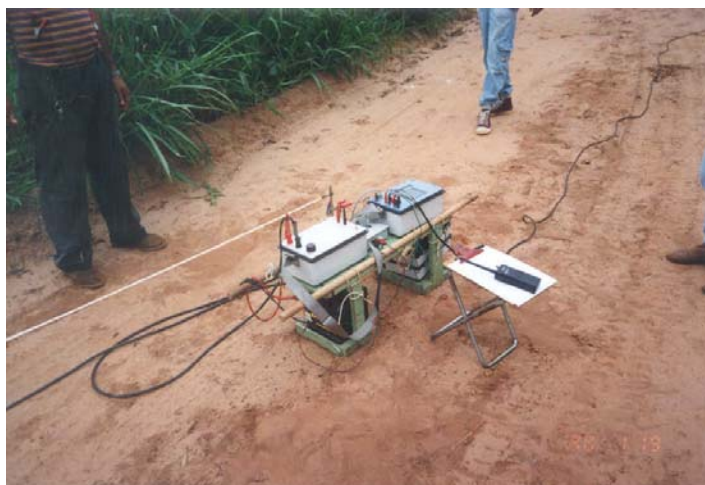
Foto 4.4: Detalhes do resistivímetro utilizado no momento da realização da 1ª campanha de Geofísica, no aterro de Bauru, realizada por técnicos do IAG da USP.
