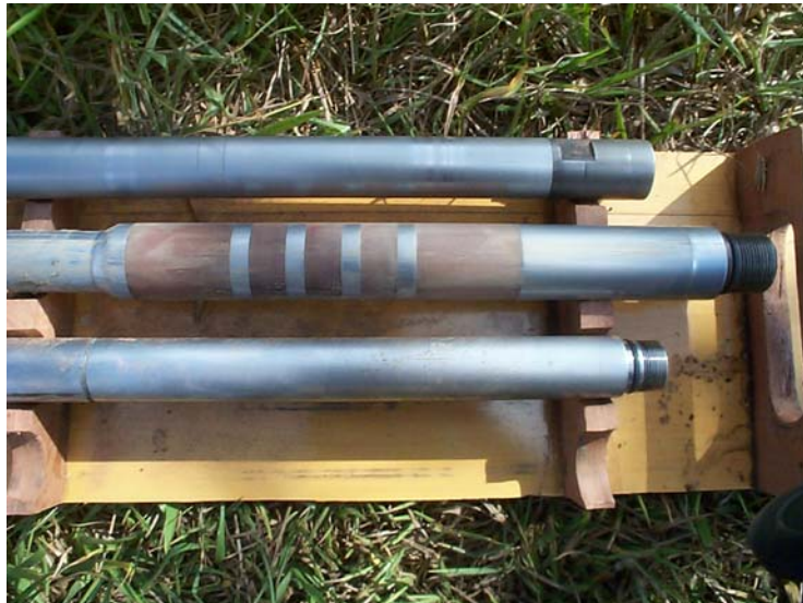
Foto 3.4 Detalhe do dispositivo para medida de resistividade acoplado ao piezocone (RCPTU) da Unesp Bauru
