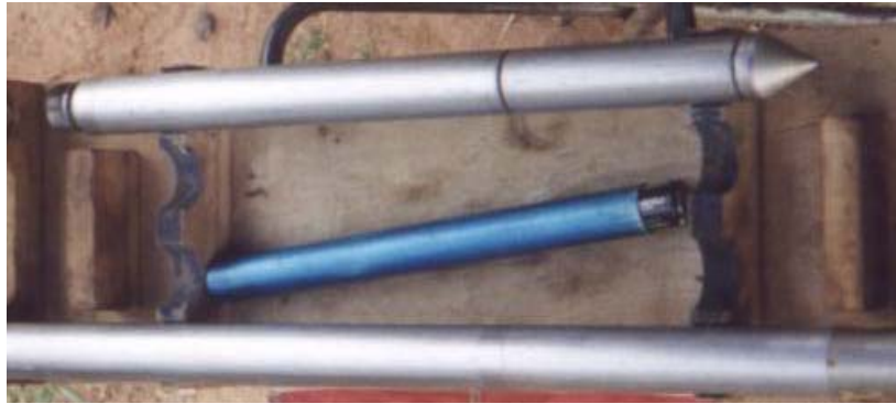
Foto 4.10: Piezocone sem fio com filtro com cavidade utilizado nas sondagens CPTU.
