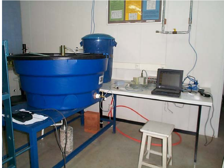
Foto 4.14: Sistema de calibração do dispositivo para medida de resistividade acoplado ao piezocone.
