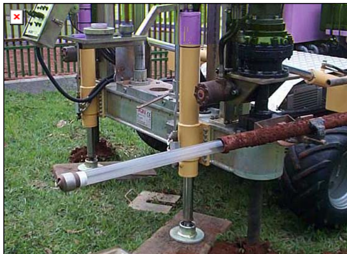
Foto 3.5: Amostrador de solo direct push
