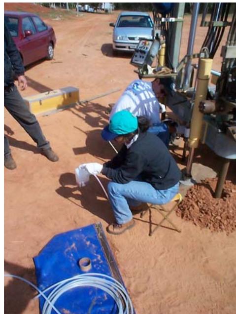
Foto 4.6: Amostragem de água na área do aterro de Bauru utilizando o Geoprobe®.
