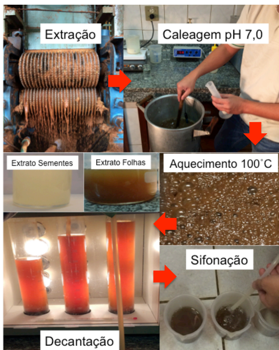
Figura 4 – Processo de clarificação do caldo de cana em escala laboratorial.
