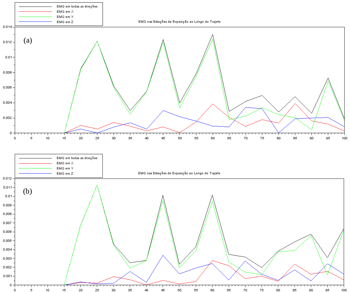
Figura 27: Processamento com janelas de quatro (a) e dois (b) eventos e avanço de base de 1 evento – Erro médio quadrático entre as coordenadas verdadeiras e ajustadas estações de exposição ao longo do percurso.
