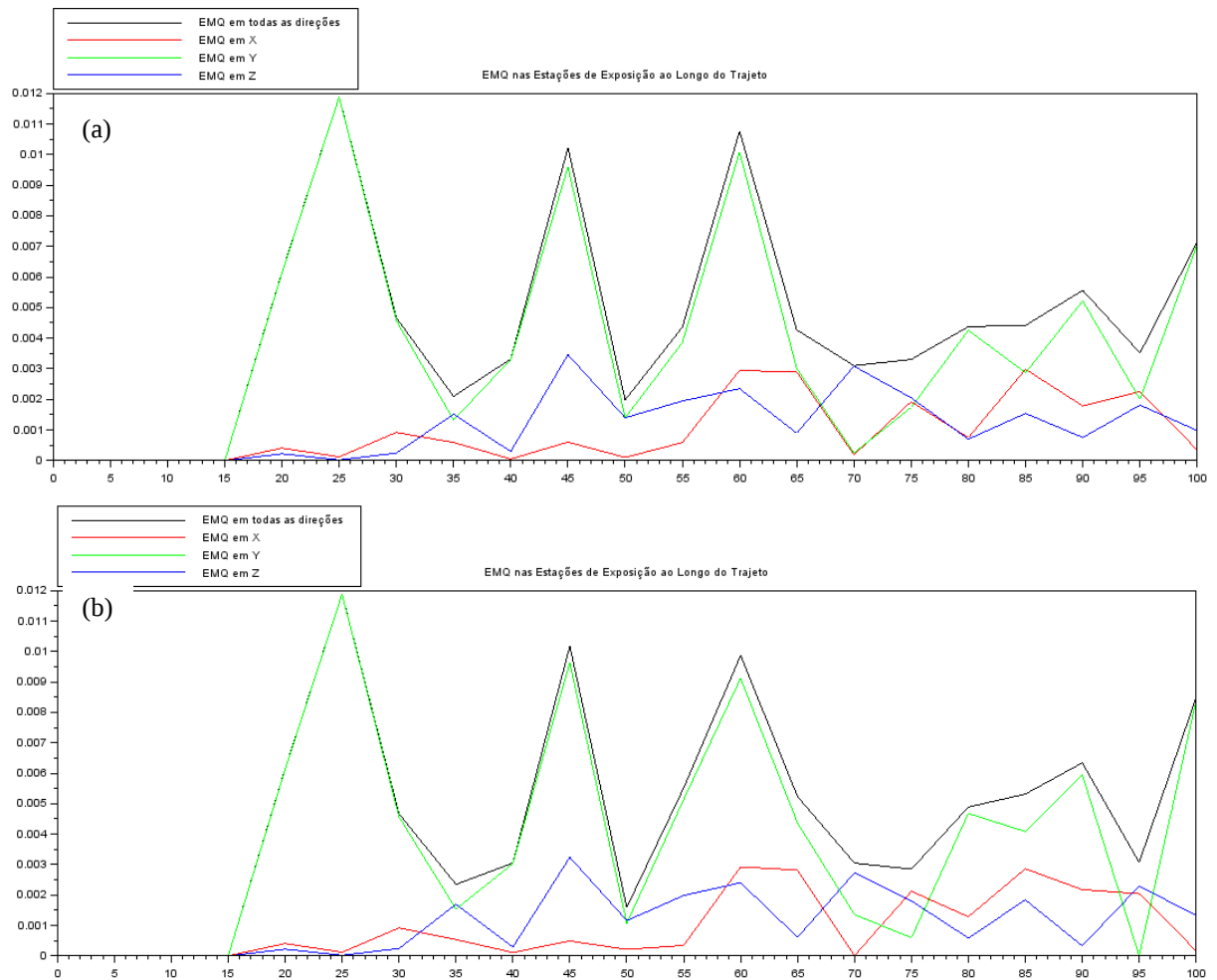
Figura 28: Processamento com janelas de 4 eventos e avanço de base de dois (a) e (b) eventos – Erro médio quadrático entre as coordenadas verdadeiras e ajustadas estações de exposição ao longo do percurso.
