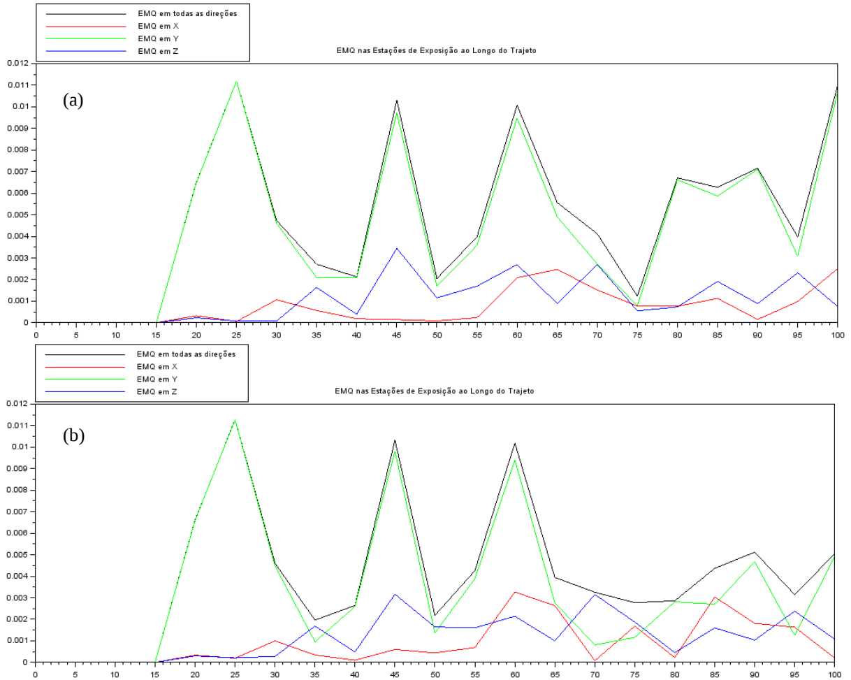
Figura 22: Processamento em lote (a) e sequencial (b) – Erro médio quadrático entre as coordenadas verdadeiras e ajustadas das estações de exposição ao longo do percurso.
