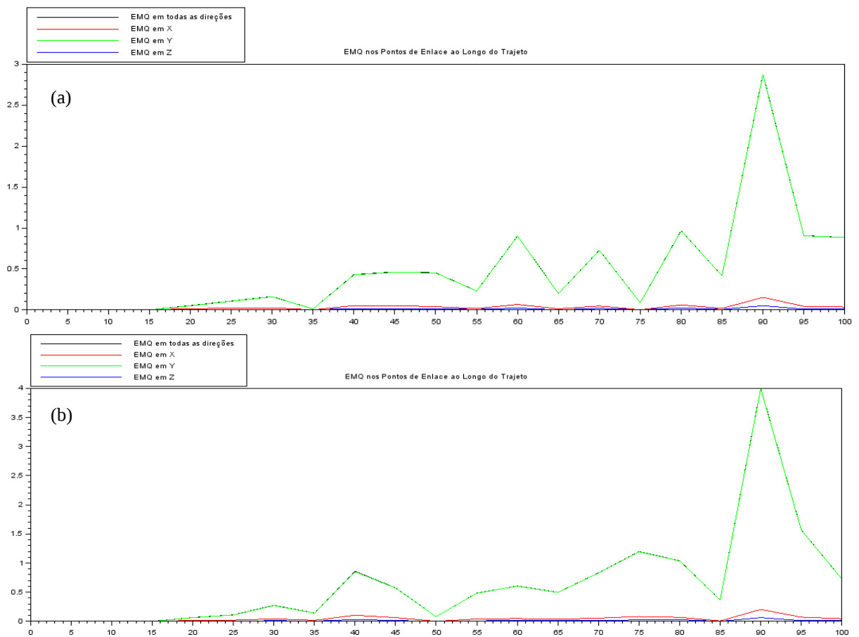
Figura 24: Processamento em lote e sequencial – Erro médio quadrático entre as coordenadas verdadeiras e ajustadas dos pontos de enlace ao longo do percurso.
