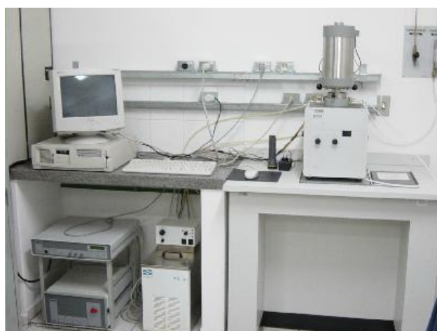
Figura 3.10 – Calorímetro diferencial e gravimétrico STA 409, Laboratório Multiusuário, DF-FC.
