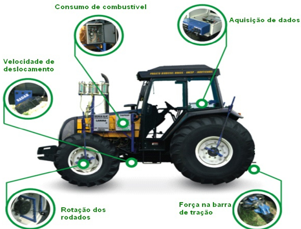
Figura 11. Vista lateral do trator de teste com instrumentação completa Fonte: Adaptado de Lopes (2006)
