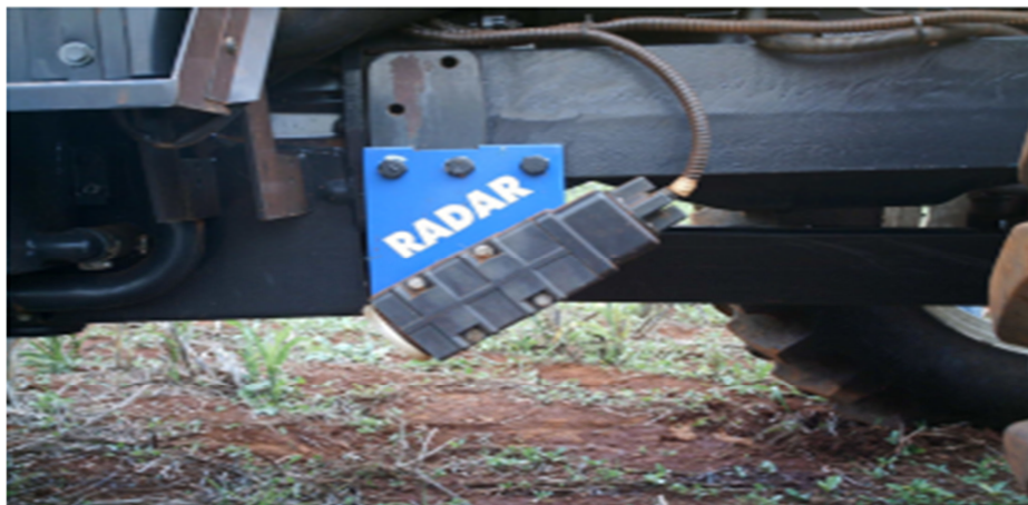
Figura 8. Radar instalado na lateral direita do trator para a determinação da velocidade real de deslocamento.
