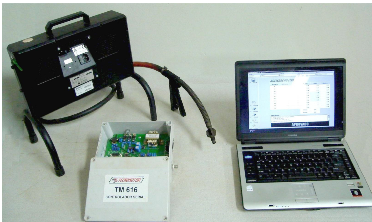
Figura 12. Instrumentação utilizada no ensaio de opacidade da fumaça.
