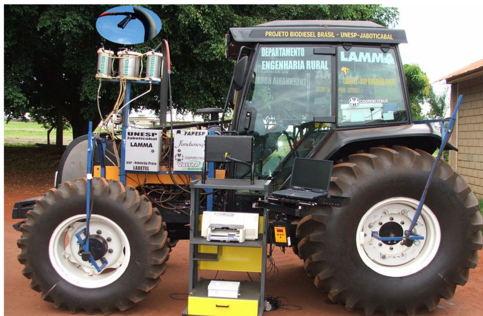
Figura 13. Vista do trator instrumentado para o ensaio de opacidade da fumaça. Fonte: Lopes, 2006.
