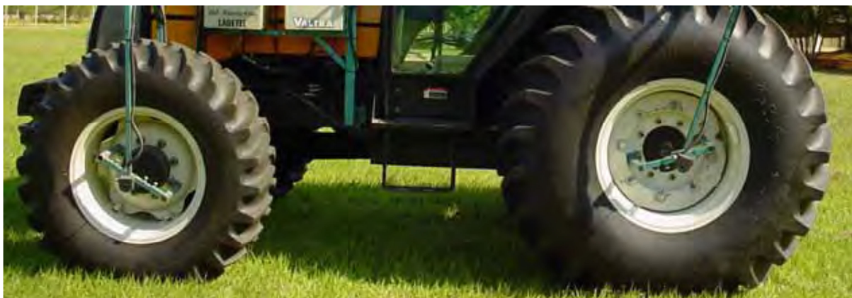
Figura 7. Sensores de patinagem dos rodados. Fonte: Lopes 2006.
