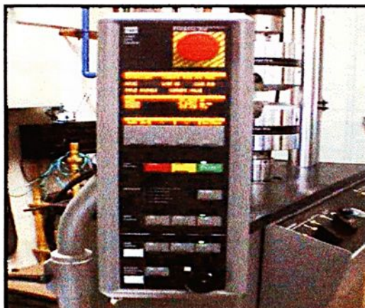
Figura 3.23 – Braço de comando da MTS – 810 para diminuir a frequência para leitura do crescimento da trinca.
