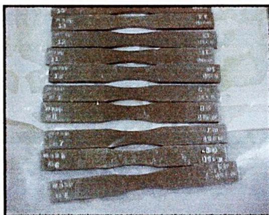
Figura 3.13 – Corpos de prova confeccionados para o ensaio da vida em fadiga.
