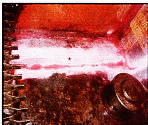
Figura 1.2 – Trinca na estrutura da mesa fixa localizada no sub solo da prensa mecânica excêntrica.
