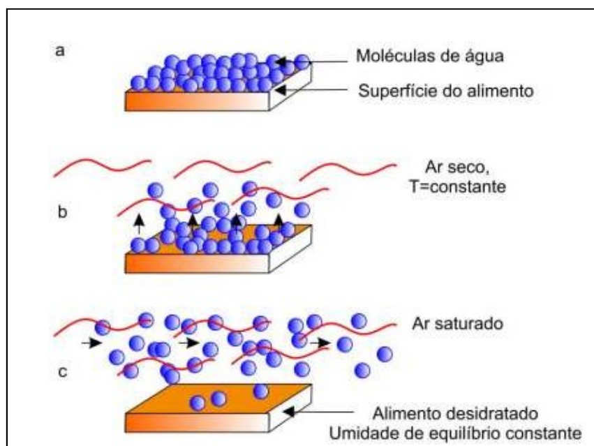
Figura 4.5 - Esquema de um processo de equilíbrio molecular entre o alimento e o ambiente.
