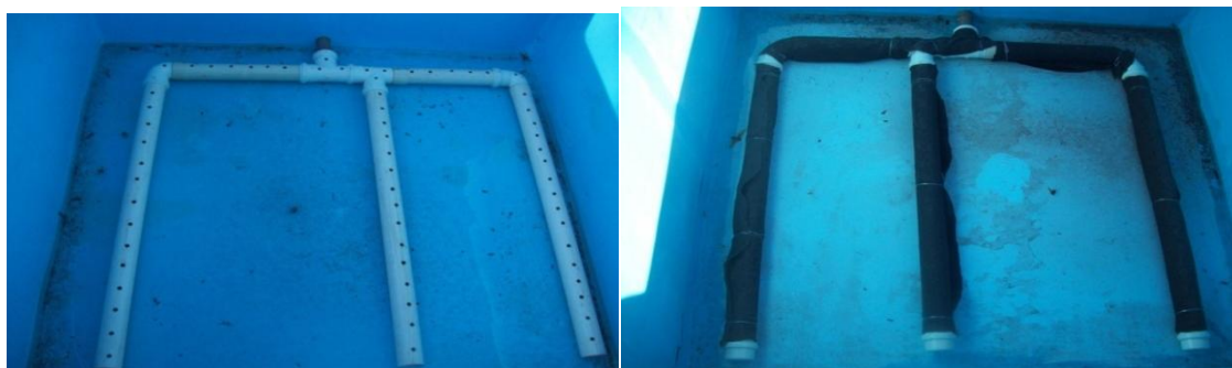
FIGURA 9. Parte inferior das caixas com as tubulações de drenagem (saída) do efluente no fundo das caixas.
