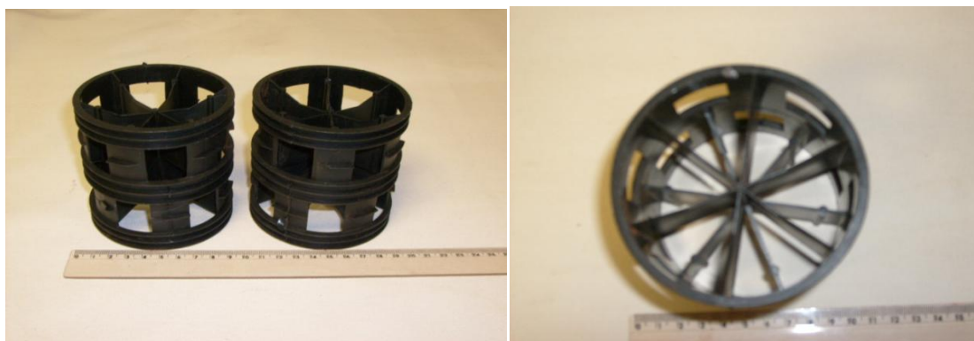
FIGURA 6. Vista lateral e superior dos anéis de polipropileno utilizados no filtro anaeróbio e filtro biológico percolador durante os cinco ensaios.
