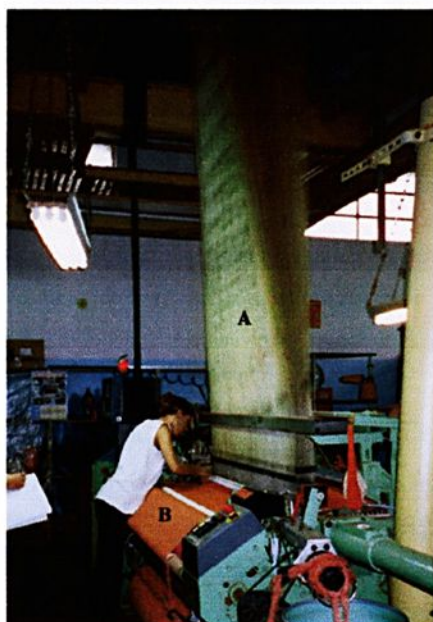
61 Tecelã trabalha no tear de jacquard na indústria Têxtil F. Deleu. Esta foto registra o tear visto de frente. A. Pavilhão; B. Tecido pronto.
