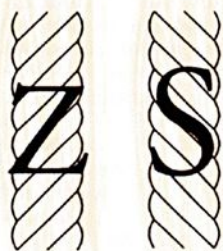
Fig.2 Torção em Z e Torção em S.
