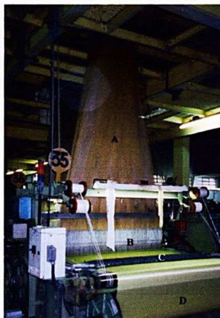
62 Tear de jacquard na indústria Têxtil F. Deleu. Esta foto registra o tear visto por trás. A. Pavilhão; B. Malha do Jacquard; C. Lamela; D. Rolo do Urdume.
