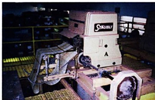
63 Maquineta do tear de jacquard, vista de cima, na indústria Têxtil F. Deleu. A. Maquineta; B. Faixa de cartão perfurado.
