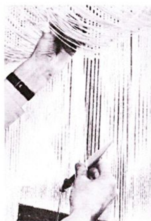
55 Movimentação dos liços e passagem do fio da trama.
