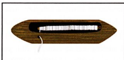
70 Lançadeira barquinha com orifício lateral por onde sai o fio da trama. Possuem geralmente de 10 a 15 cm de comprimento.
