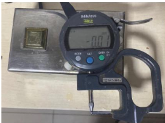
Figura 7. Micrômetro para aferição da espessura da casca.
