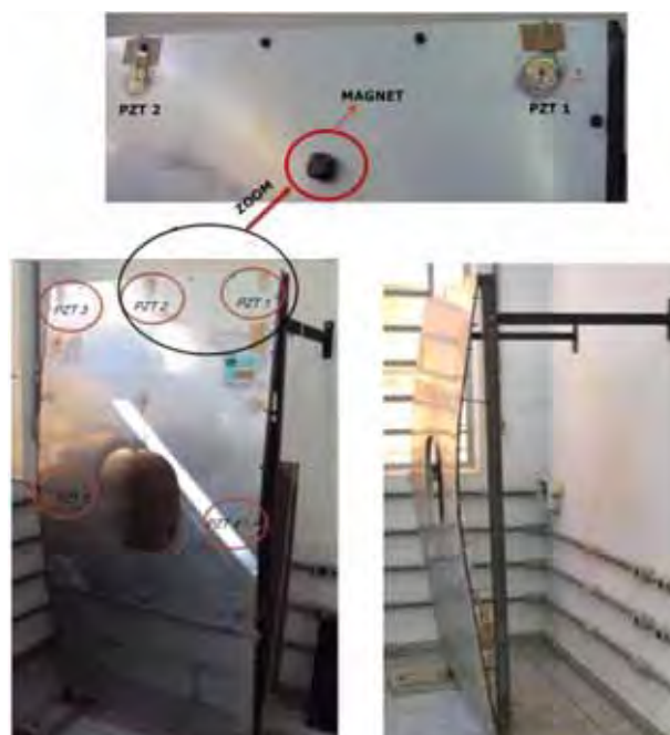
Figura 34 – Fotos do painel aeronáutico contendo os transdutores PZT e o ímã.
