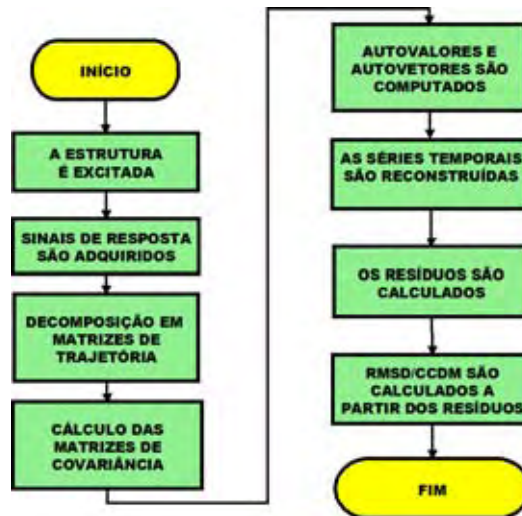
Figura 68 – Diagrama contendo procedimento para o método baseado na SSA.
