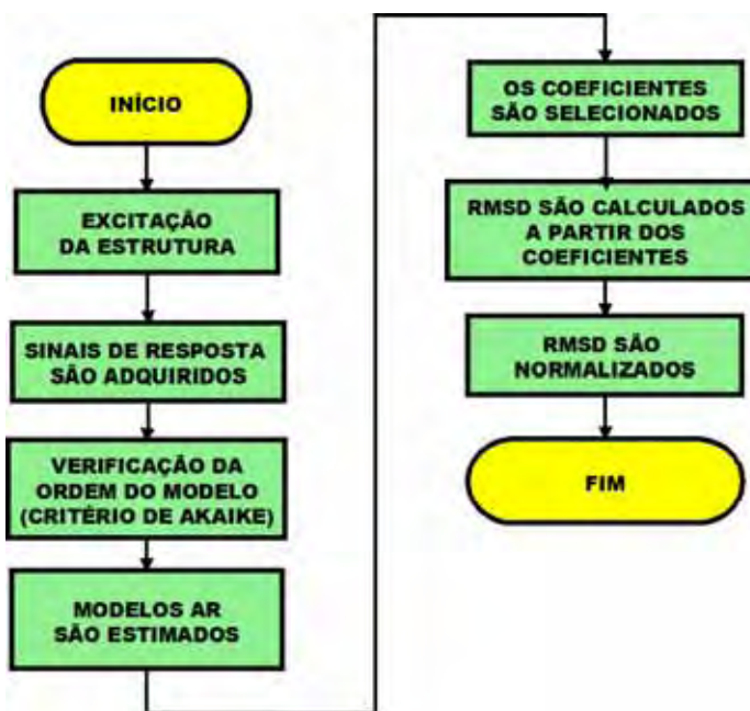
Figura 8 – Diagrama contendo o método baseado na análise de modelo AR.
