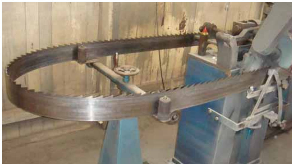
Figura 06. Serra utilizada no processamento da madeira passando pelo processo de afiação em serraria na região de Itapeva/S.P.
