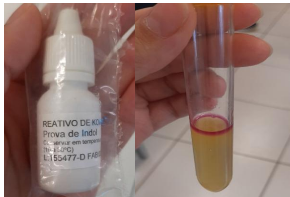
Figura 22. Frasco de Reativo de Kovacs, à esquerda, e tubo com amostra de água após utilização do reativo e formação de halo vermelho, à direita. Fonte: arquivo pessoal, 2025.
