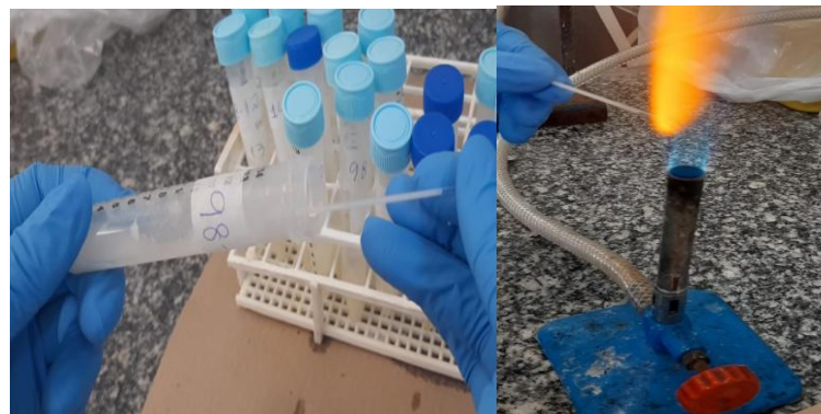
Figura 28. À esquerda, realização da coleta da amostra por meio de tubo capilar e, à direita, vedação do tubo capilar com auxílio do bico de Bunsen. Fonte: arquivo pessoal, 2025.
