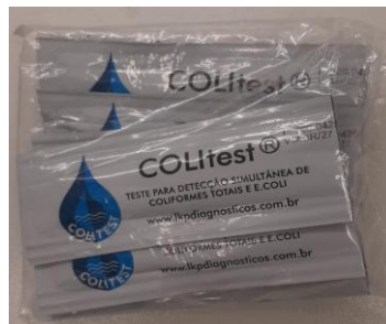
Figura 20. Sachês de COLItest® para detecção de coliformes totais e E. coli em amostras de água. Fonte: arquivo pessoal, 2025.
