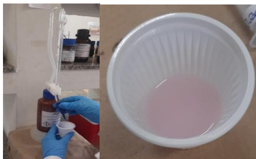
Figura 26. Realização da titulação com solução Dornic, à esquerda, e mudança de cor do leite de branco para rósea, à direita. Fonte: arquivo pessoal, 2025.
