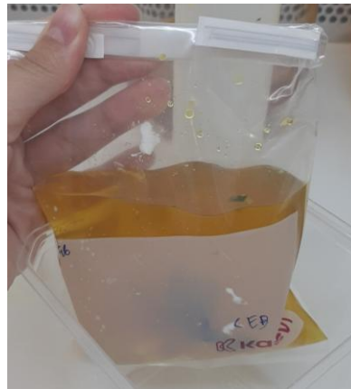
Figura 34. Amostra (25g) acondicionada no saco plástico estéril junto de 225 mL de caldo LEB. Fonte: arquivo pessoal, 2025.
