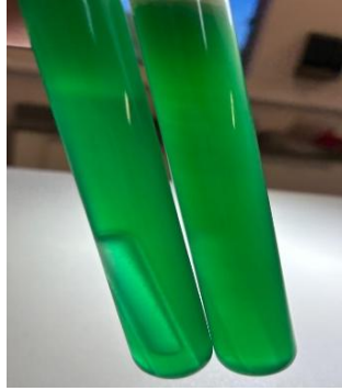
Figura 19. Tubo de Durham, à esquerda, com gás na sua parte interna, indicando presença de coliformes totais na amostra. Fonte: arquivo pessoal, 2025.
