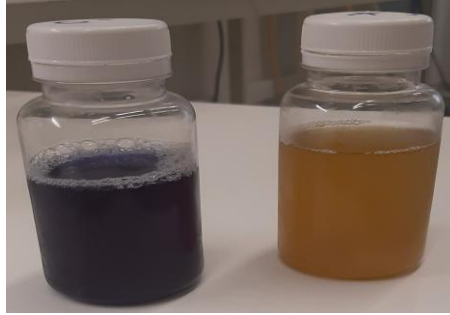
Figura 21. Frascos com amostras de água após adição do COLItest® e permanência por 48h em estufa a 36 °C, evidenciando a ausência de coliformes, à esquerda, e a presença de coliformes, à direita. Fonte: arquivo pessoal, 2025.
