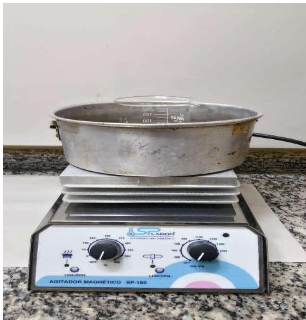
Figura 8- Imagem da solução filmogênica de gelatina em banho-maria e em agitação
