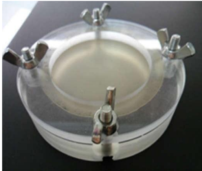
Figura 11 - Célula contendo o filme utilizada para as medidas de permeabilidade ao vapor
