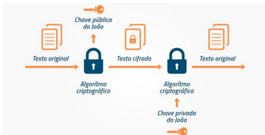
Figura 3.5: Algoritmo de criptossistema com chaves assimétricas
