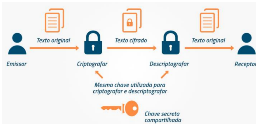
Figura 3.4: Algoritmo de criptossistema com chave simétrica
