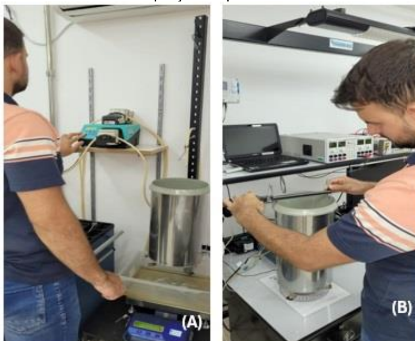
Figura 21. A) Configuração da bomba peristáltica. / B) Medições do diâmetro da área de captação do pluviômetro
