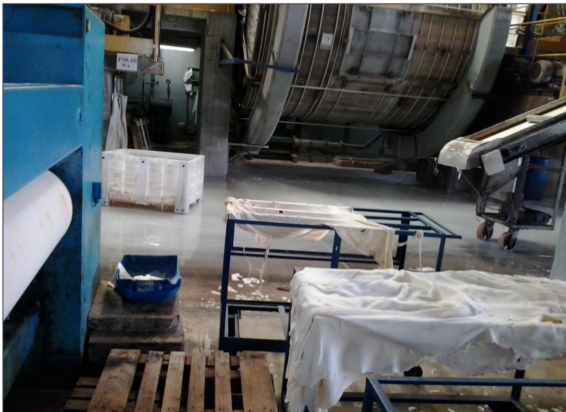
Figura 2 – Fulão, equipamento de curtimentos de couros
