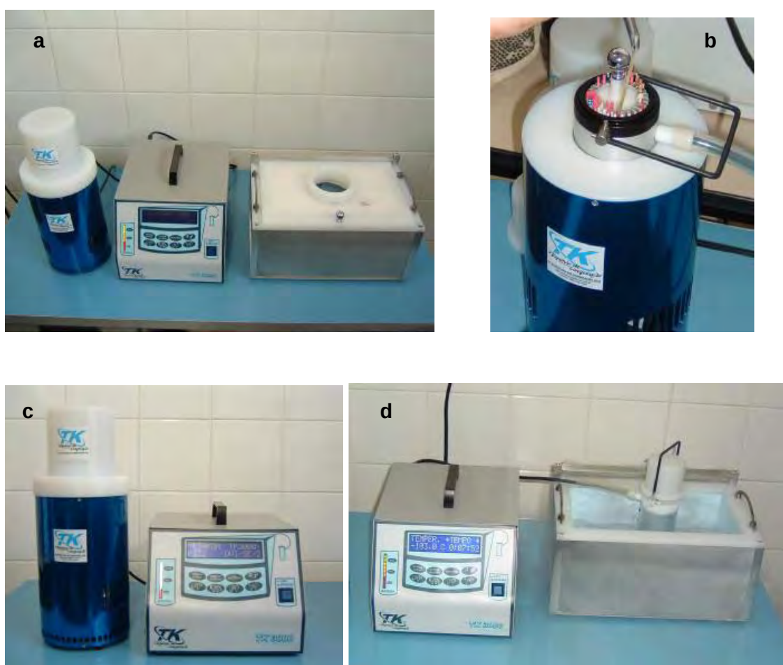
FIGURA 2: Sistema automatizado de refrigeração e congelação de sêmen - (a) partes integrantes do sistema, (b) acondicionamento das palhetas no cilindro, (c) fase de refrigeração e (d) fase de congelação.
